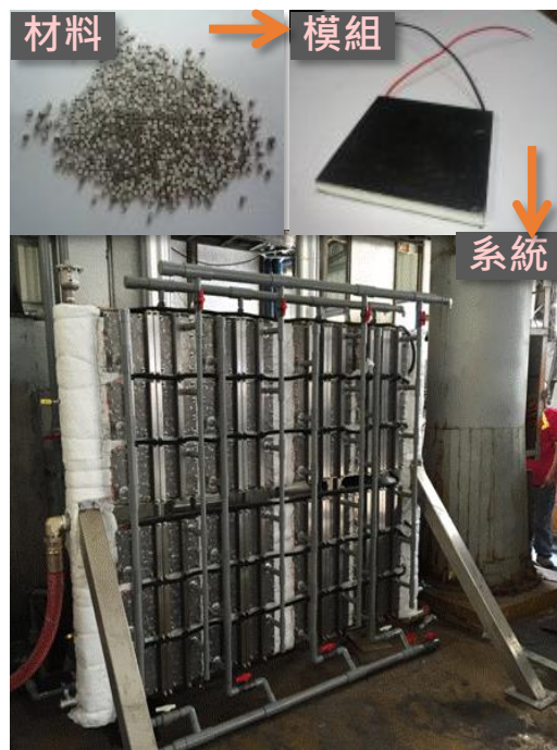
鍋爐廢熱水發電系統
