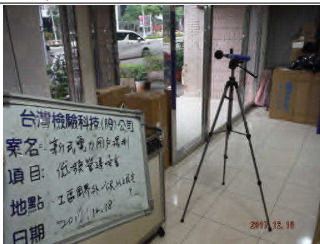
監測項目：低頻噪音 監測地點：工區周界外一公尺以上民宅 監測時間：2017.12.18
