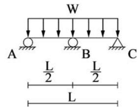
[D] 14. 如右圖所示，一梁長度為2L，受均佈載重W時，試求最大彎矩M數值為何？
