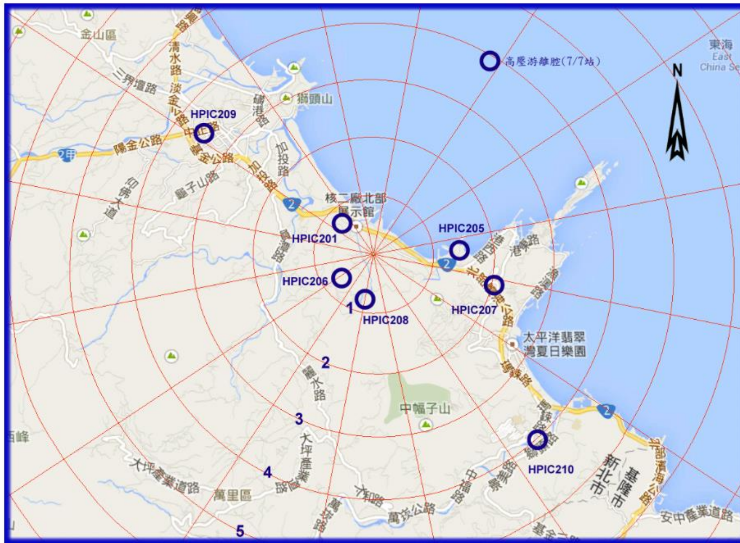
圖 3 核能二廠高壓游離腔監測站分佈圖
