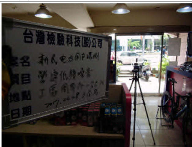
監測項目：低頻噪音 監測地點：工區周界外一公尺以上住宅 監測時間：2017.06.08
