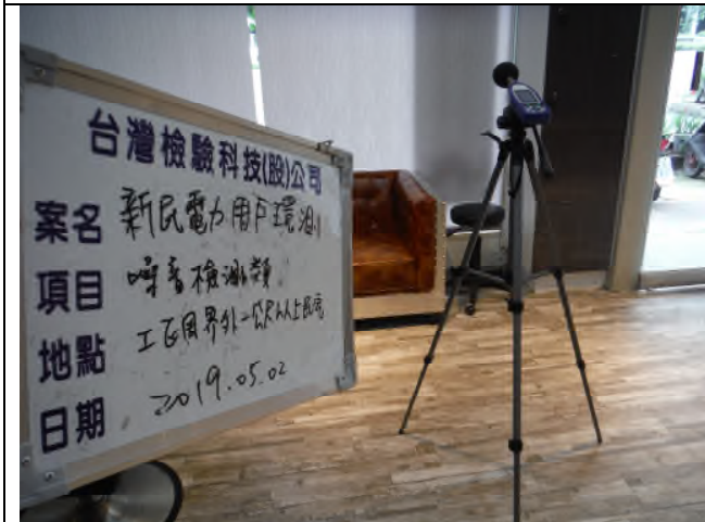
監測項目：低頻噪音 監測地點：工區周界外一公尺以上民宅 監測時間：2019.05.02
