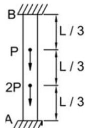
44. 如右圖所示之構件，全長為 $3L$ ，斷面積分別為 $A$ 、 $2A$ 及 $3A$ ，彈性係數均為 $E$ ，試求構件總縮減量為何？
