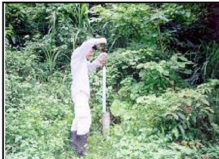
照片 2-2 地下水質GM9監測井採樣情形
