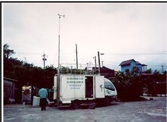
照片2-1 貢寮焚化廠入口旁民宅測站 空氣品質監測情形
